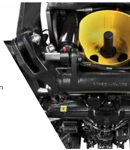
Y la función TDF Auto (solo con elevador electrónico) que permite la parada y la reactivación de la toma de fuerza en función de la posición de subida o bajada del elevador trasero.
