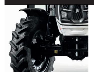
El sistema de frenos en las 4 ruedas está incluido de serie en todas las versiones de doble tracción. Esta solución, junto con el acoplamiento electrohidráulico de la doble tracción, garantiza un gran nivel de seguridad y cortas distancias de frenado. Lagama Cronotambiénestá disponible con el sistema de freno hidráulico para remolque con función Dual-Mode, qu cumple los requisitos de las últimas directivas de seguridad.
