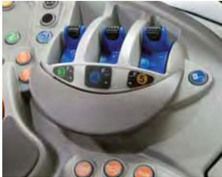
La polyvalence de la gamme Nitro se retrouve au niveau de la prise de force : embrayage multidisque à bain d'huile, régimes 540/540E/1000/1000E tr/min et prise de force proportionnelle à l'avancement.
