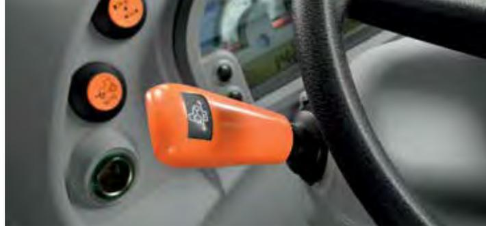
**Die angemessen abgestuften Übersetzungen** sorgen für eine dynamische, komfortable und flüssige Schaltung. Dank der **Overspeed-Funktion** ist der reibungslose und angenehme Fahrbetrieb auf der Straße (40 km/h) im Sparmodus-Drehzahlbereich möglich.
