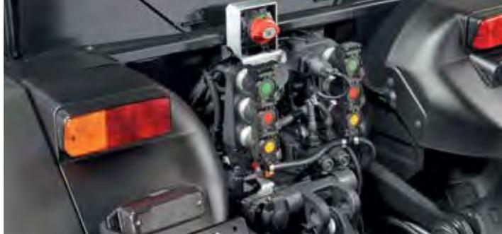
Der mechanische oder optional erhältliche elektronisch gesteuerte **Heckkraftheber** mit einer Hubkraft von 2600 kg ermöglicht das problemlose Ankuppeln aller Arbeitsgeräte und deren präzise und zuverlässige Regelung.
