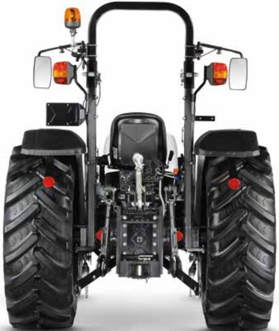
**Vierradbremssystem** mit nassen Scheiben und Allradzuschaltung bei den Crono-Modellen mit Allradantrieb (bei den 40 km/h Varianten).
