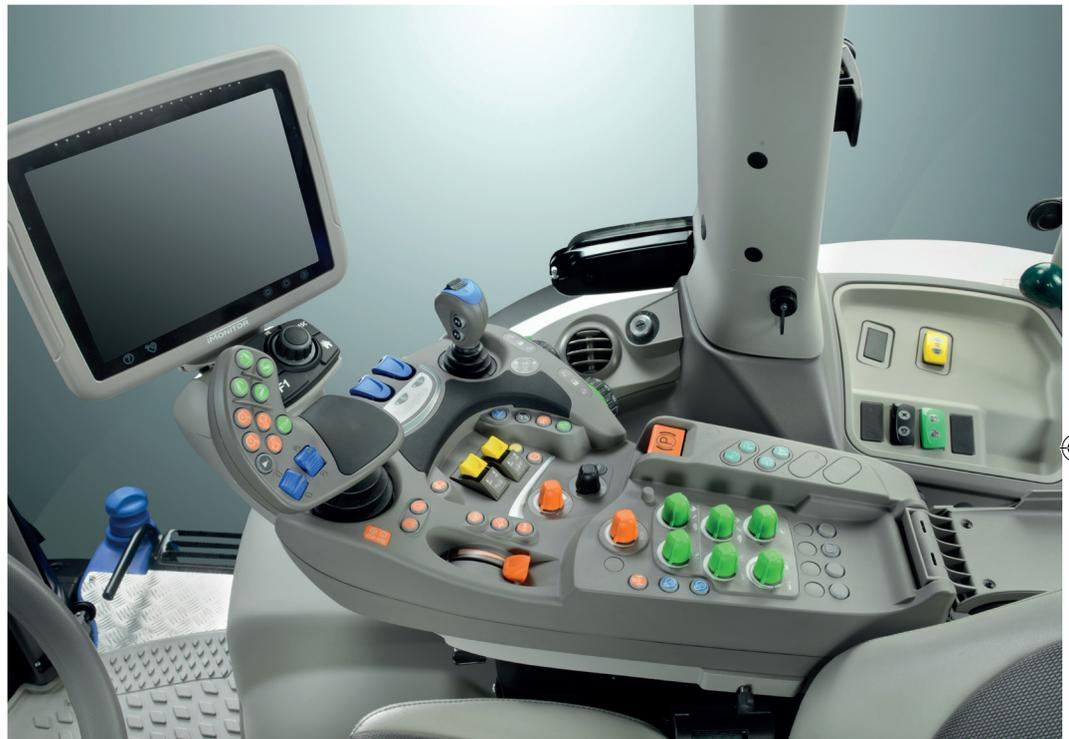
Das hochkomfortable VRT-Getriebe arbeitet dank seiner vier mechanischen automatisch geschalteten Gruppen extrem effizient. Motor- und Getriebemanagement sind voll und ganz integriert. Bis zu vier Fahrgeschwindigkeiten können gespeichert werden, um den Arbeitsablauf zu optimieren.
