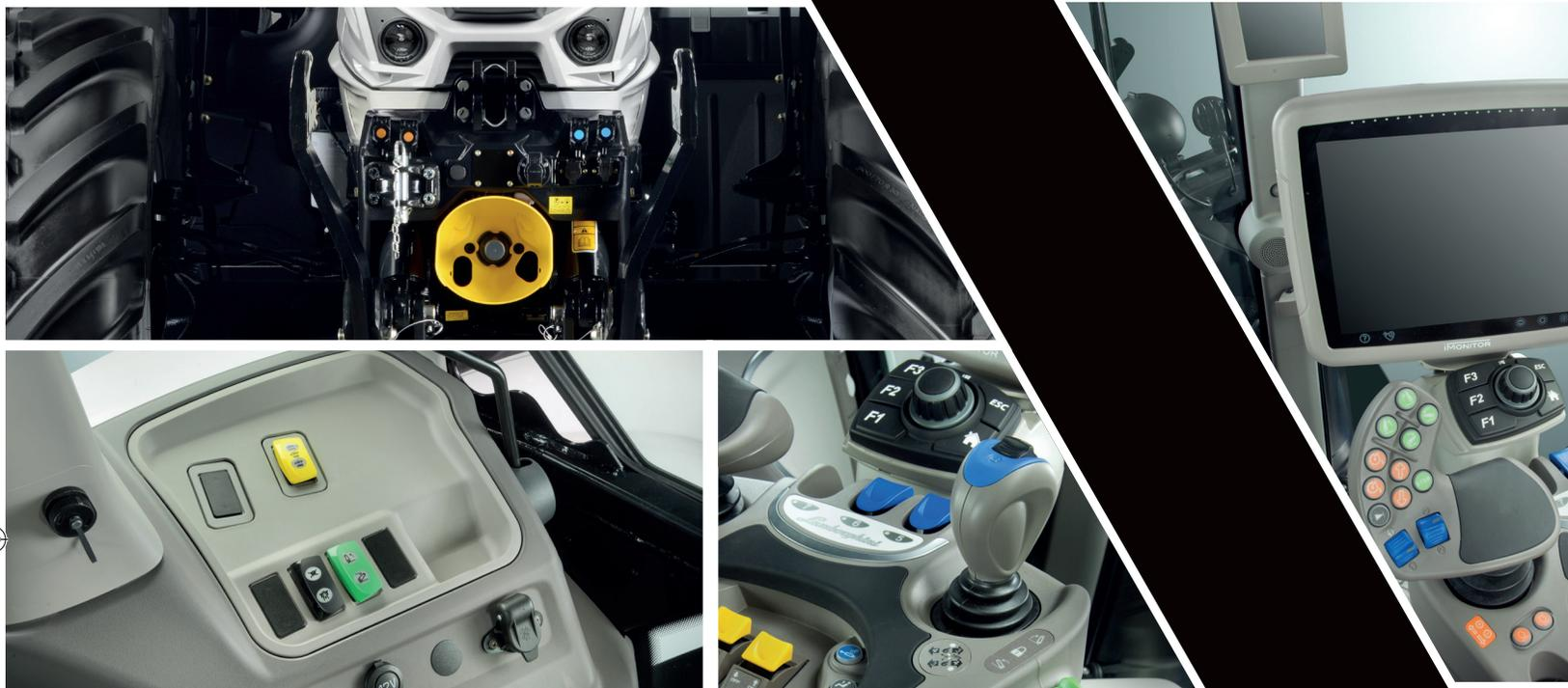
Das neue Hydrauliksystem des Mach ermöglicht den Anbau eines positionsgesteuerten Frontkrafthebers. Die Hubkraft beträgt beachtliche 5.480 kg. Darüber hinaus befinden sich die Vorsatzgeräte dank des neuen Frontkraftheberkonzepts wesentlich näher am Traktor, was die Hubkraft deutlich erhöht und für eine bessere Balance sorgt. Eine ISOBUS-Schnittstelle ist ebenfalls im Frontanbauraum integriert.
