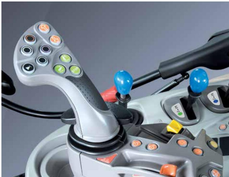
Modus aktiviert. Er hält die Zapfwellendrehzahl bei Fahrtgeschwindigkeitsänderungen konstant.
