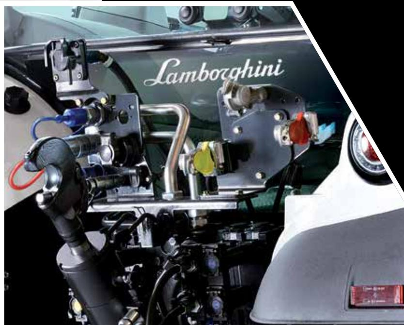
fein abgestufte Bedienung der Arbeitsgeräte ermöglicht. Ein getrennter Ölhaushalt sorgt bei den VRT-Modellen über längere Zeit für sauberes Öl. Dies vergrößert die Wartungsintervalle. Je nach Kundenbedürfnissen ist eine Load-Sensing- oder Konstantpumpe verfügbar.
