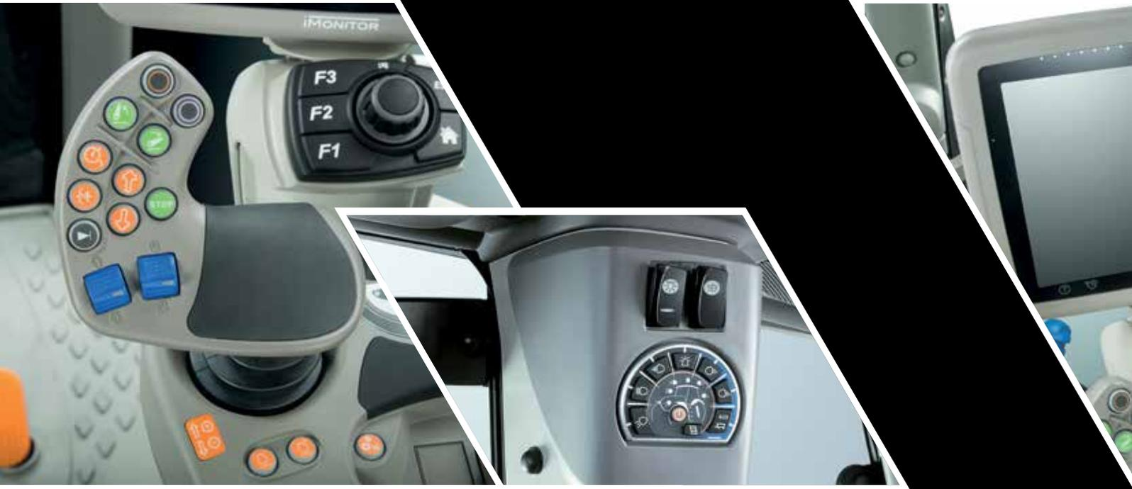
Dank der neu gestalteten Armlehne ist der neue Spark 155 - 215 noch komfortabler und intuitiver zu bedienen. Alle Routinefunktionen können automatisiert werden. Mit dem neuen, hochergonomischen MaxCom-Joystick in der Armlehne lässt sich alles steuern - von Fahrgeschwindigkeit und Fahrtrichtung über den Tempomat bis hin zum ComfortTip-System sowie Front- und Heckkraftheber. Bei allen Modellen können die Front- und Heckkraftheber je nach Konfigu-
