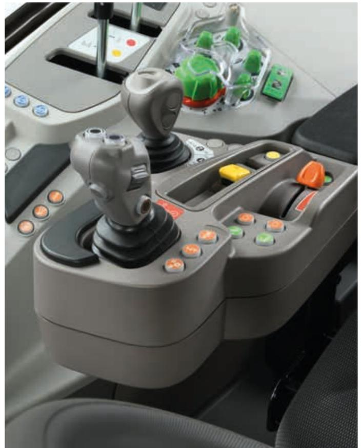
La transmisión RVshift del Lamborghini Spark R también dispone de dos ajustes (Normal y Heavy Duty) para optimizar la fuerza de tracción en función del trabajo que se esté realizando. En todas las velocidades, desde la 1ª hasta la 15ª, la transmisión puede cambiar de gama en función de la carga del tractor. La gama Heavy Duty también se puede seleccionar manualmente mediante un botón específico situado en la consola derecha de la cabina.
