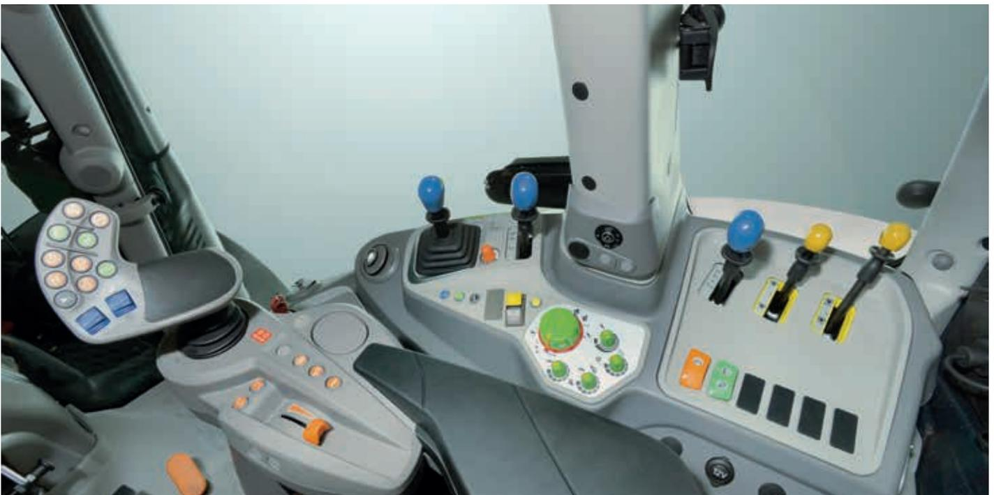
En los modelos RCshift, la transmisión está completamente automatizada, gracias a la gestión robotizada de las 5 gamas mediante un software exclusivo de Lamborghini Trattori, que permite trabajar tanto en modo semiautomático como en modo manual.
