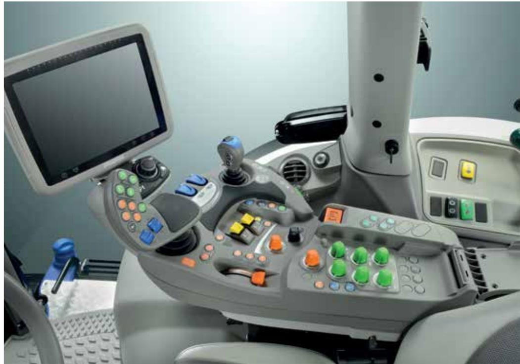
La función "Trailer-Stretch" aumenta la seguridad en caso de transporte con remolque, mientras que la función de parada activa "PowerZero" permite que el conductor detenga y mantenga el tractor en su posición (incluso en pendientes y con remolque) simplemente soltando el pedal del acelerador, sin usar los pedales de freno, la palanca del inversor o el pedal del embrague.
