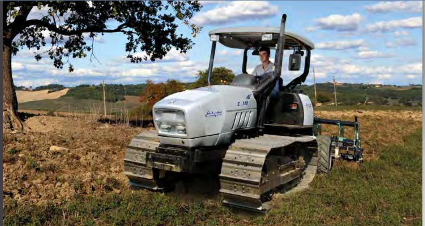
El cambio mecánico permite afrontar todas las necesidades de uso: los C SIX y CF se han diseñado con un cambio mecánico 16+16, que puede suministrarse con minirreductor o, para los trabajos extra lentos, con superreductor (velocidad mínima de 0,61 km/h).
