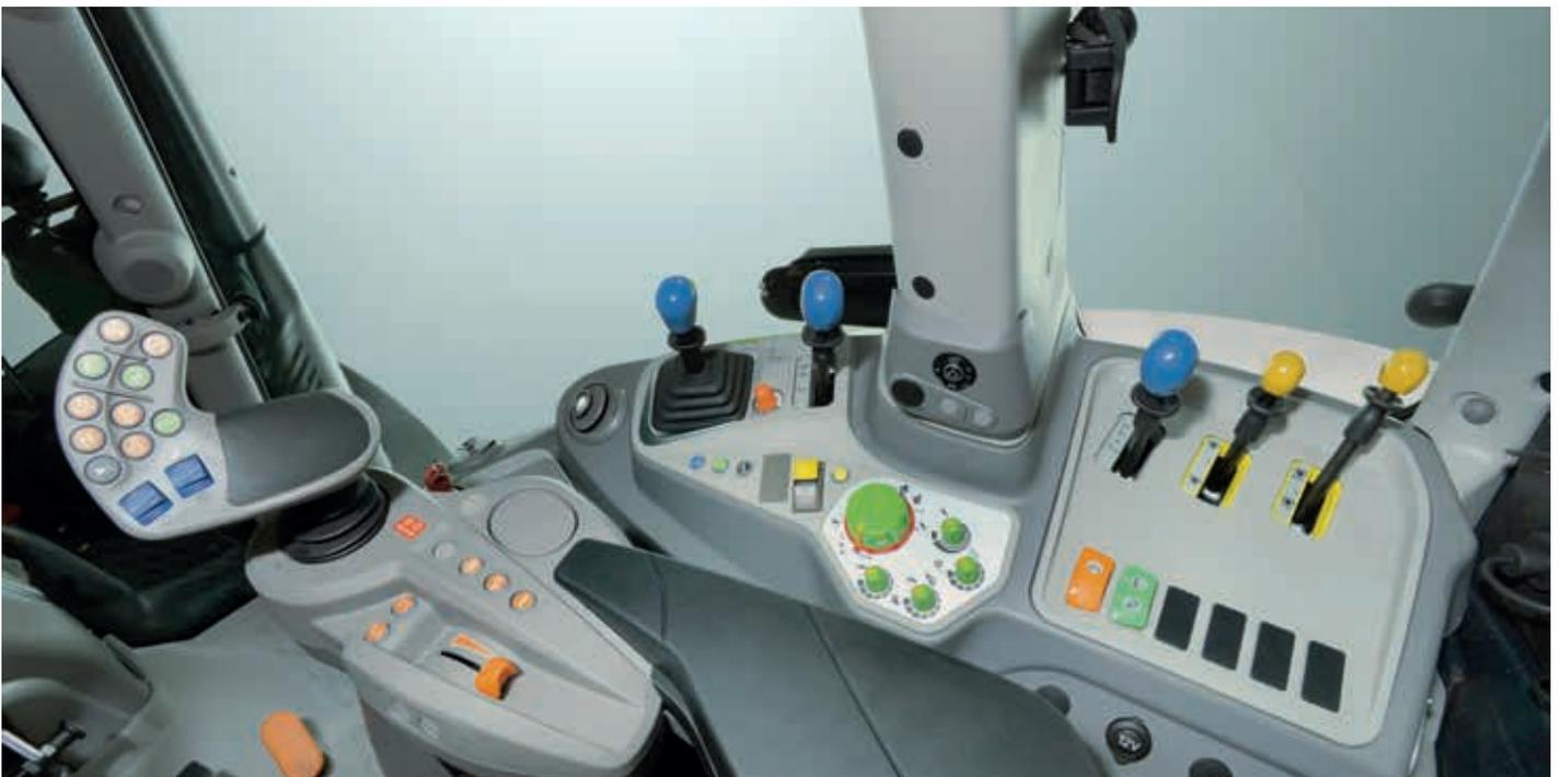
Sur les modèles RCshift, la transmission est complètement automatisée, grâce à la gestion robotisée des 5 plages de vitesse, supervisée par un logiciel exclusif Lamborghini Trattori ; mais il est aussi possible d'opérer en mode semi-automatique et manuel.
