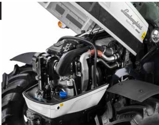
permis de placer dans une zone protégée le catalyseur DOC et le nouveau filtre à air PowerCore à deux étages, qui peut être équipé d'éjecteur de poussière sur demande. Pour faciliter l'entretien, outre l'installation de deux grilles coulissantes pratiques pour protéger les radiateurs, tous les points d'intervention pour les contrôles périodiques ont été rendus plus facilement accessibles.
