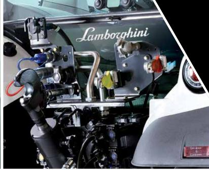
: sur les modèles 155, 165 et 175 avec transmission Powershift ou RCshift, un système à centre ouvert avec pompe de 84 l/min est monté de série, mais une pompe Load Sensing 120 ou 160 l/min est disponible sur demande. En revanche, sur les modèles 185, 205 et 215 avec transmission Powershift ou RCshift et sur tous les modèles VRT, le système Load Sensing à pompe de 120 l/min est de série et, en alternative, celle de 160 l/min (voire 170 l/min pour les modèles 155, 165, 175 et 185
