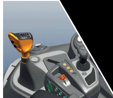
manuel, pour un total de 30+15 vitesses (qui passent à 54+27 avec le réducteur). Tous les modèles disposent d'un inverseur hydraulique, le ComfortClutch permettant de changer de rapport sans devoir agir sur le pédale d'embrayage; ils disposent aussi de la fonction Stop&Go et du SpeedMatching. Les vannes proportionnelles permettent d'obtenir une sensation de conduite semblable à celles des tracteurs équipés d'une transmission VRT, mais avec l'efficacité typique des Powershift.
