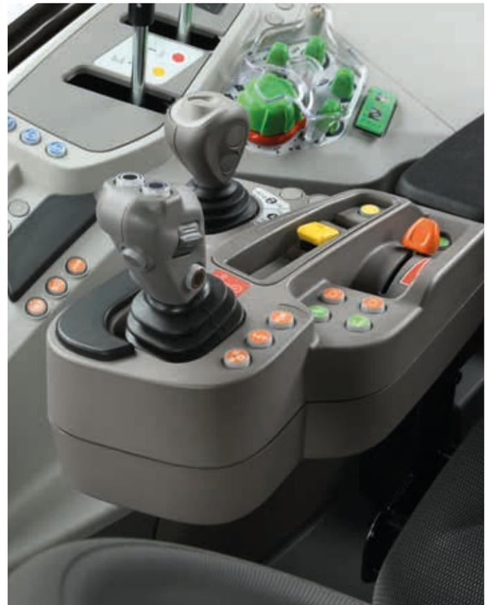
La transmission RVshift du Lamborghini Spark R Stage V dispose également de deux réglages (Normal et Heavy Duty) pour optimiser la force de traction en fonction du travail effectué. À toutes les vitesses, de la 1<sup>e</sup> à la 15<sup>e</sup>, la transmission peut passer d'une gamme à l'autre en fonction de la charge du tracteur. La gamme Heavy Duty peut également être sélectionnée manuellement à partir d'un bouton spécifique situé sur le tableau de bord droit de la cabine.
