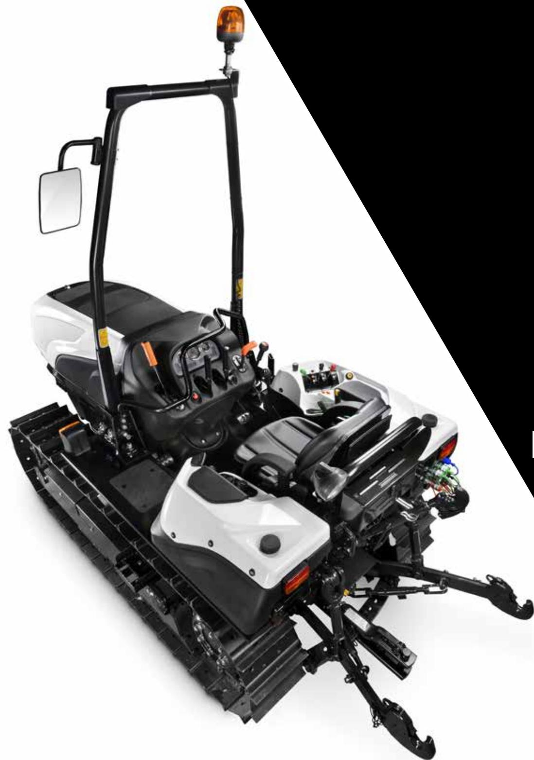
acier de 400 mm, conçues et produites avec les dernières technologies et soumises à de nombreux essais sur le terrain pour offrir une fiabilité maximale et des performances d'excellence absolue. Cette solution augmente non seulement la stabilité de la machine grâce à un empattement qui atteint 1 663 mm, mais réduit sensiblement les dommages de la végétation lors des manœuvres en tournière. Dernier
