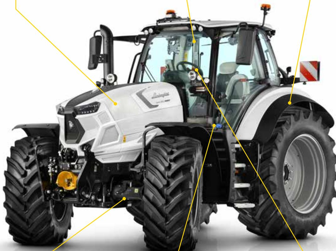
Transmission Powershift avec option APS (Automatic Powershift) ou transmission robotisée RCshift avec jusqu'à 54 vitesses en marche avant et 27 vitesses en marche arrière [réducteur compris].
