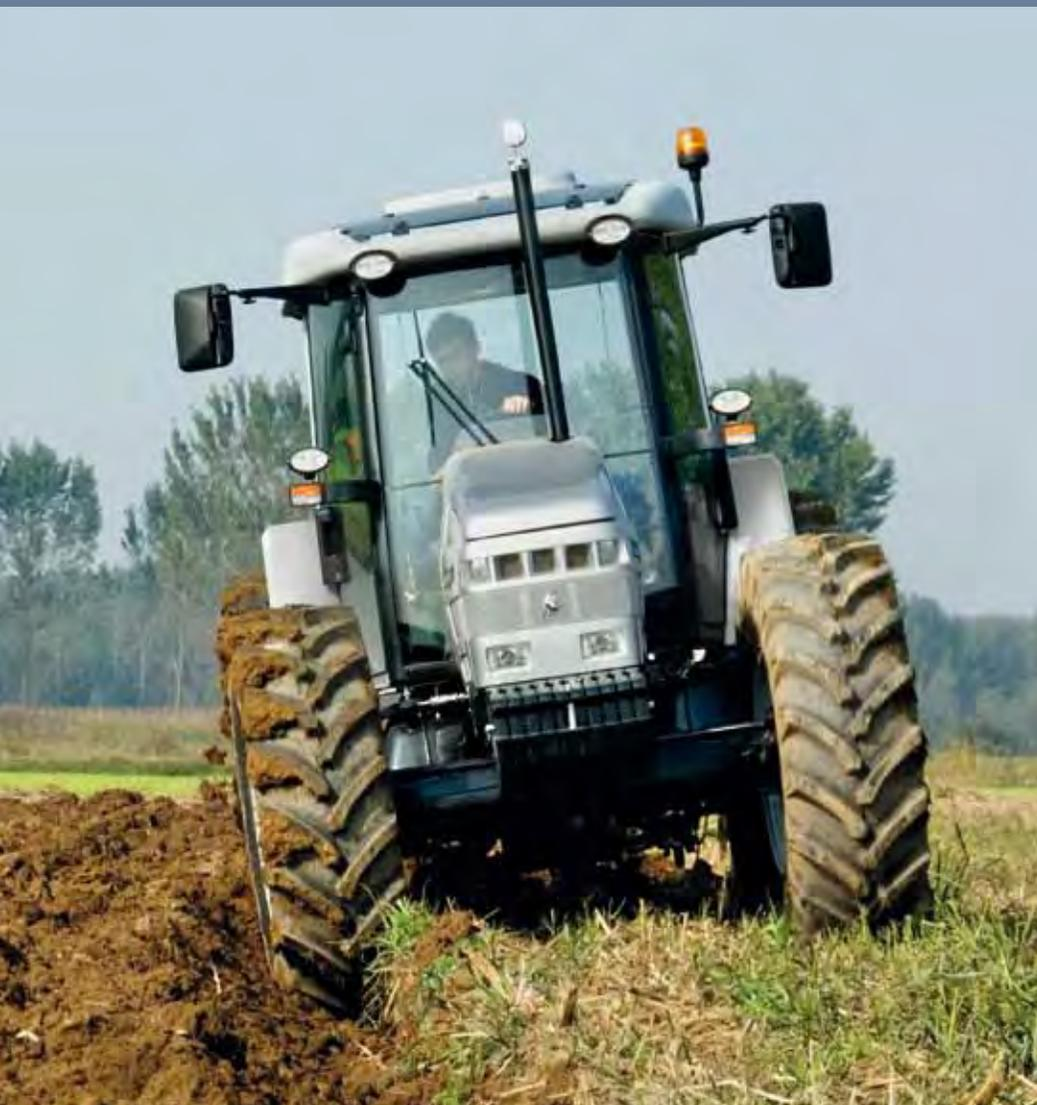
Un circuit hydraulique spécifique alimente la direction assistée qui, grâce aux doubles vérins de direction, donne de la légèreté et de la fluidité au volant, pour travailler dans les meilleures conditions même lorsque le régime est bas. Le pont AV assure un angle de braquage de 50°.
