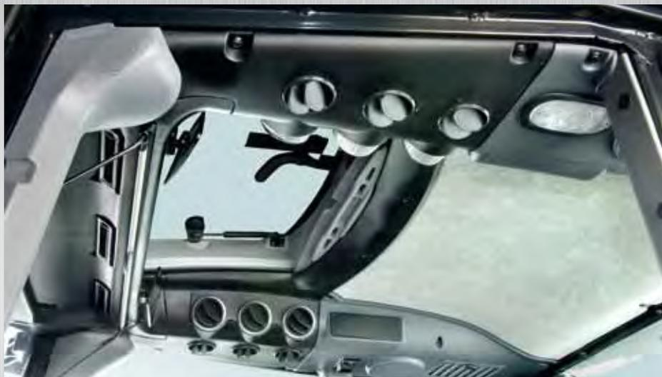
■ Un système de ventilation (climatisation sur demande) à 4 vitesses distribue, à travers 18 buses réglables, un flux d'air idéal en adaptant la température à l'intérieur de la cabine pour assurer le confort optimal de l'opérateur, quelles que soient les conditions climatiques.
