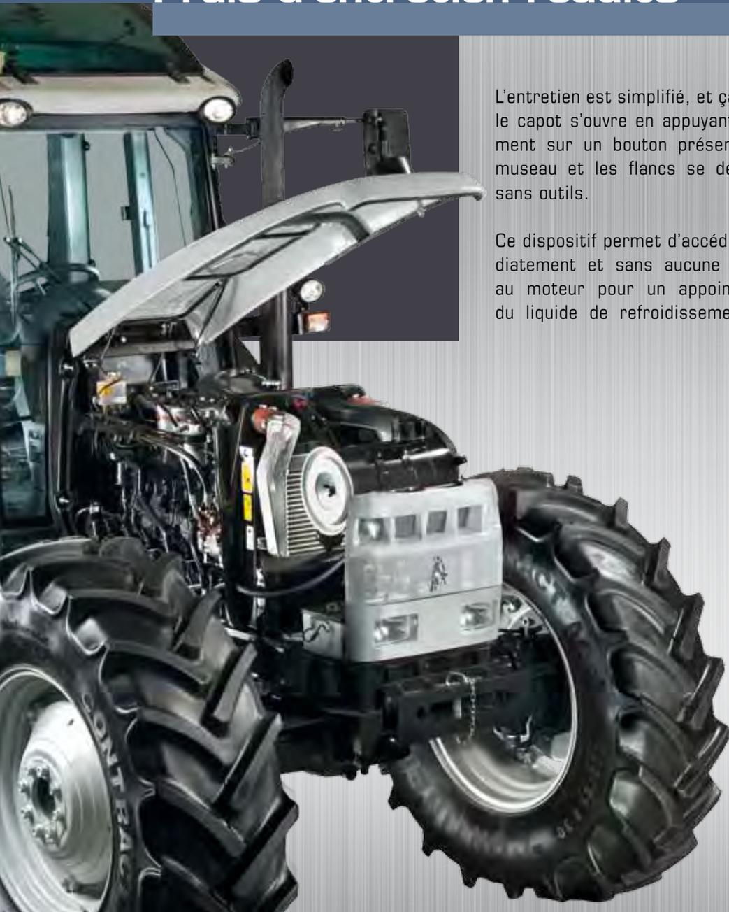
L'entretien est simplifié, et ça se voit: le capot s'ouvre en appuyant simplement sur un bouton présent sur le museau et les flancs se démontent sans outils.
