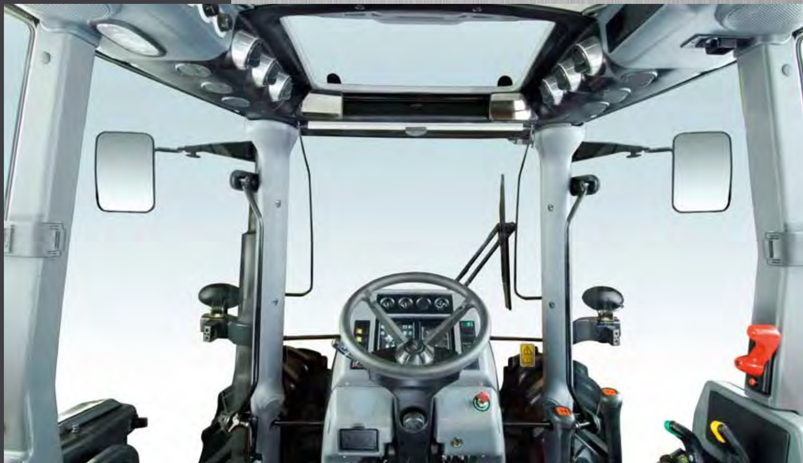
■ Znakomitą widoczność zapewnia umieszczenie rury wydechowej na słupku kabiny.
