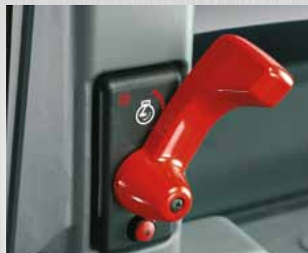
■ Dźwignia gazu ręcznego umieszczona na środkowym słupku kabiny. Możliwość zapamiętania prędkości obrotowej silnika.
