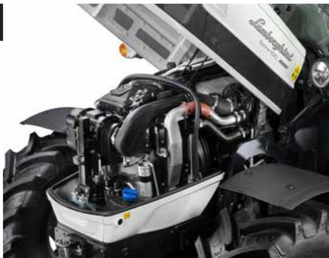
de bruscas da carga. Com a nova disposição da parte de baixo do capot, o conversor catalítico DOC é situado numa área abrigada e protegida juntamente com o novo filtro de ar PowerCore de 2 estágios (que pode ser instalado, a pedido, com um sistema de eliminação de poeiras). Para facilitar a manutenção, todos os pontos de inspeção e serviço são mais facilmente acessíveis e o grupo dos radiadores agora está protegido por dois painéis de rede deslizantes.
